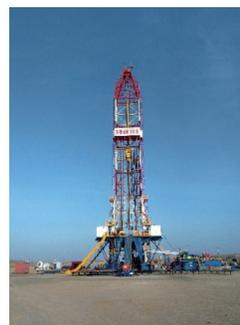
该项目研发了国内地勘行业首台5000米多功能交流变频电动钻机,创新了自动平衡起降直立式井架、钻机整体自移、高塔防寒防暑、钻杆提升自动洗刷、集视频与通讯功能的安全帽等技术,改善了人机工作环境,显著提高了钻探工作效率和安全性;研发了泥浆性能多参数一体化自动测量装置,实现了泥浆粘度、密度、失水量、含砂
