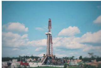
“一键式”钻机通过机器人自动感知、精准定位、智能协同等技术,在井口区8 m<sup>2</sup>范围内整合11种设备的360余个动作,实现了并行自动化作业。“一键式人机交互”就是控制人员只需按下下一个按键,就能实现钻机多个设备的协同联动和数据的实时交互,帮助钻井工人高效完成复杂的作业任务。
