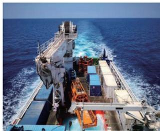
进行了目标层保压取心钻探作业,持续时间约15 h。“海牛Ⅱ号”钻机本体高7.6 m,腰围10 m,体重12 t,水下重力10 t(100 kN),是目前我国水下最重的地质勘探科考设备。
