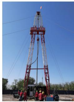
该项目自工作任务书下达之后,项目团队充分发挥现有设备优势,精心组织,创新工艺,采用转盘水源钻机和CHD127绳索取心钻杆进行绳索取心钻进。施工过程中,不断优化改进绳索取心钻具和钻头结构,对传统水源钻机进行自动化升级,实现了恒压送钻给进,强化泥浆使用维护管理等施工措施,创新性探索出“水源钻机+绳索取心+取心钻具内衬PVC管+全孔裸眼”施工工艺,高质量完成了该项目钻探施工任务。其中,ZK03钻孔于2021年7月2日完钻,终孔深度2729 m、终孔直径133 mm、岩心直径68 mm、岩心采取率93.8%,创造了国内覆盖层钻探P口径绳索取心钻进最深纪录。
