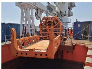
相比较于目前世界上深海海底钻机海底100余米的最大钻探深度,“海牛Ⅱ号”本次海底目标层保压取心钻探深度达到231 m,意义非凡。它不仅是目前世界上唯一一台海底钻探深度>200 m的深海海底钻机,其采用全新的基于海底钻机绳索取心技术的水合物保压取心原理、保压取心技术与
