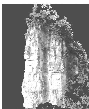
图3 东南面危岩带三维激光扫描图
