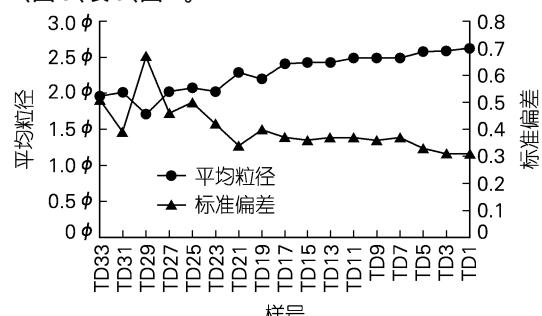
图2 连岛沙坝西侧海滩沉积物平均粒径和标准偏差自西(左)向东(右)变化趋势
