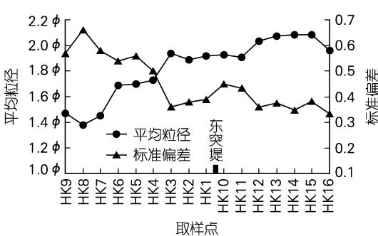
图3 河口东突堤两侧沉积物平均粒径和标准偏差自东(左)向西(右)变化趋势
