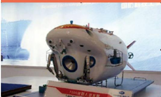
航速度1节，水下工作时间可达6小时，可载3人，作业系统为七功能主从式机械手1只、七功能开关式机械手1只。2010年6、7月在中国南海进行了3000米海试，最深处潜到3759.39米，成功突破了世界海洋的平均深度，并要在2011年进行5000米海试。将要完成对热液喷口和海洋矿产资源的采样和探测，考察海洋地质，研究浮游生物、微生物和海底生物，也可以进行深海打捞等海底作业。
