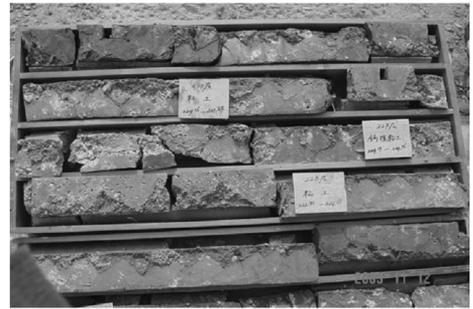
图4 用改进后的异径接头钻具取得的部分粘土层岩心
