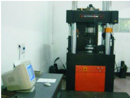
图 9 INSTRON-1346 型电液伺服材料试验机
