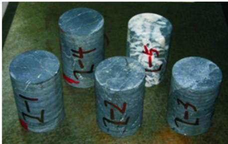
图 8 抗压强度试验用岩石样品
