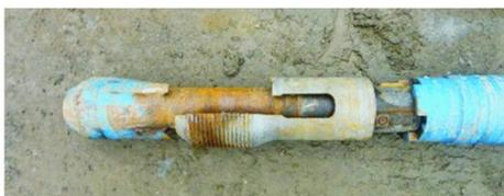
图1 损坏的可退式打捞矛
