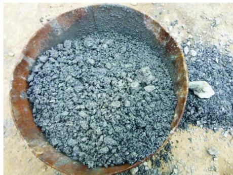
图3 采用取粉管取出的孔内沉淀岩粉
