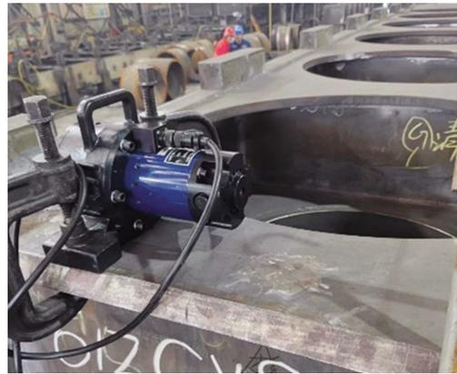
图6 固桩架振动电机放置图
