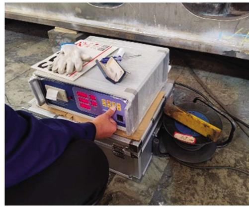
图7 振动时效控制仪
