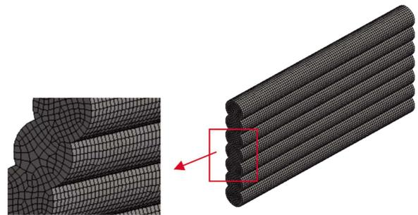
图2 相交圆柱摆模型网格
