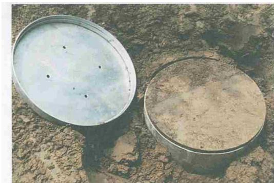
图2 取土环刀取原状土柱
