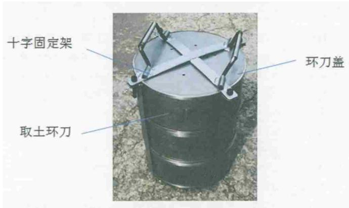
图1 原状土柱取土装置
