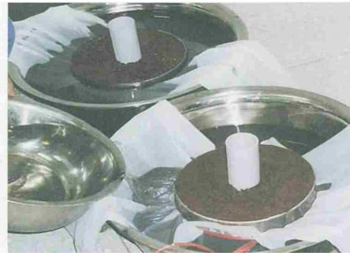
图3 浸泡原状土柱
