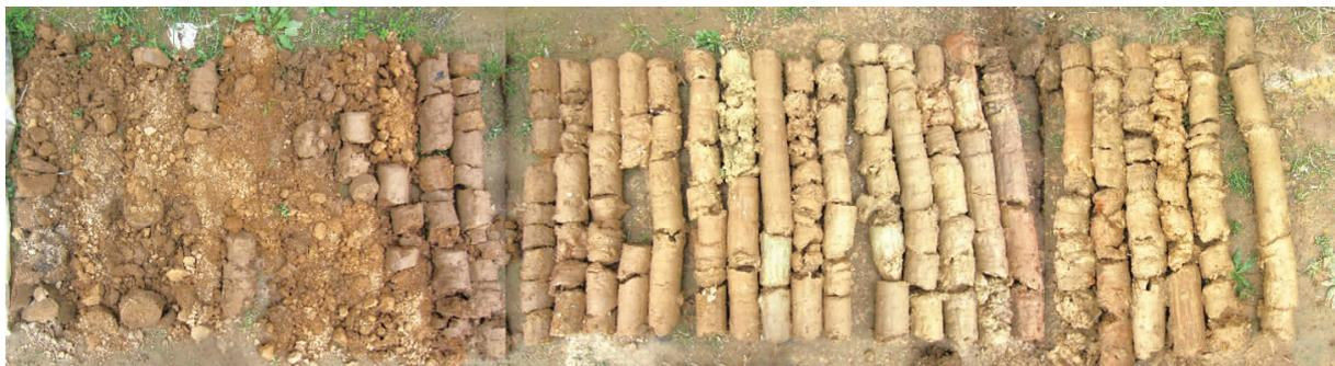
图2 白家堡子滑坡ZKB-05钻孔岩芯(31.0 m)
