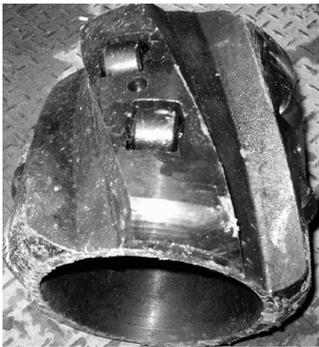
图 2 螺旋形滚轮扶正器
