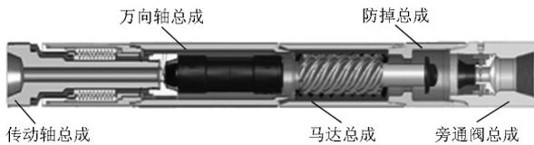
图 1 国产螺杆钻具结构图
