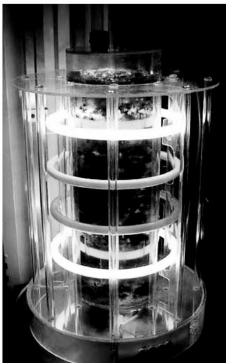
图 1 气升式藻类生物反应器(10 L)
