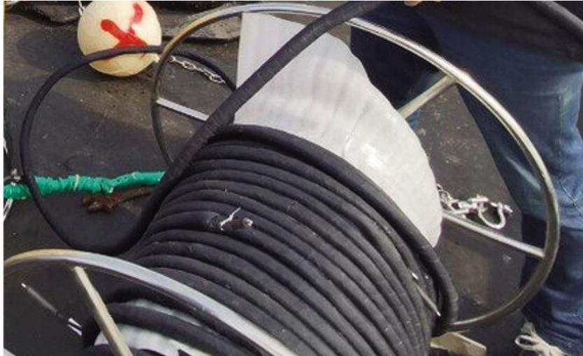
图 16 缠绕在绞盘机上的温度链
