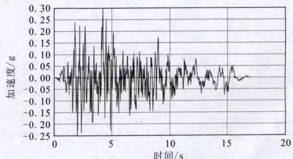
图3 地震加速度时程曲线
