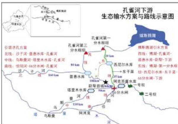
图3 孔雀河生态输水路线示意图
