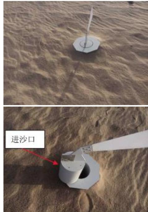
图2 微梯度集沙仪野外图片<sup>[25]</sup>
