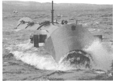
图1 “海蛇”波浪发电装置
