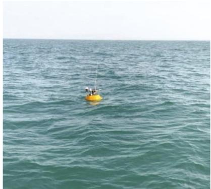
图 9 SBF7-1 型波浪浮标漂浮状态
