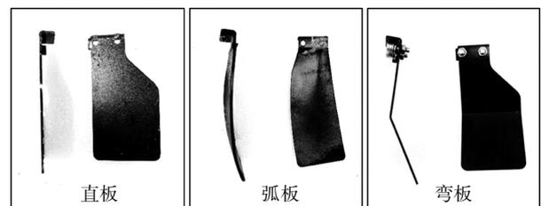
图 5 实验中采用的不同曲度的蹼板
