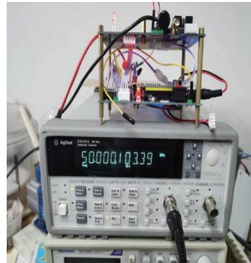
图 9 晶振稳定性测试示意图
