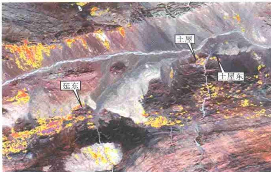
图 3 土屋—延东斑岩铜矿地区 ETM<sup>+</sup> 蚀变遥感异常图
