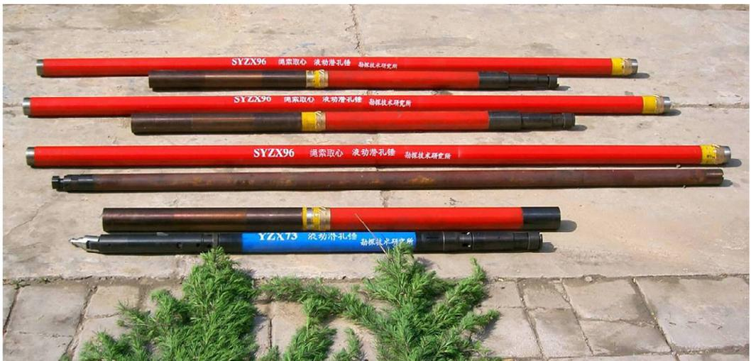
图 1 YZ、YZX、SYZX 和 HHP 系列液动潜孔锤
