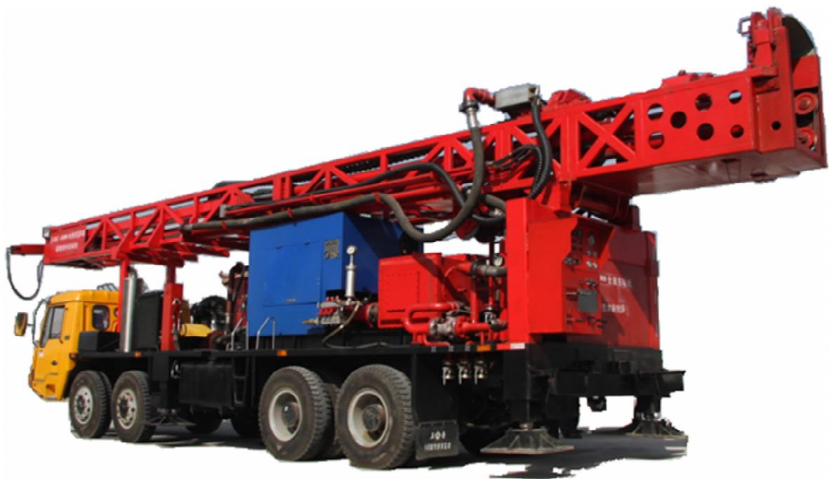
图 4 SDC1000 全液压力头车装钻机
