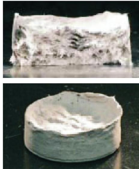
图3 FORM - A - BLOK 脱水后形成的堵漏塞
